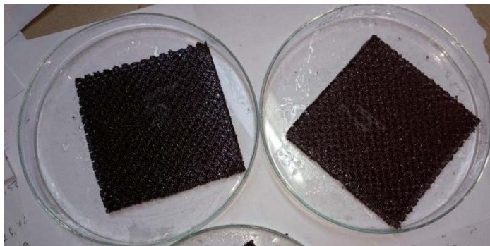
Fig. 2.9 Spacer-3D după impregnare cu glicerină
