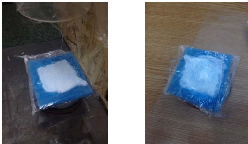
Fig. 3.9 Două straturi de material poros F133 îmbibate cu pastă de dinți îmbibat cu pastă de dinți inițial pe o arie de 60x60mm (stânga) ce nu s-a extins după impact (dreapta)
