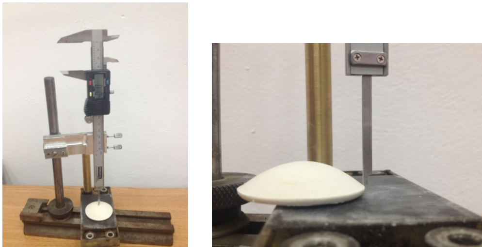
Fig. 3.12 Măsurarea negativului amprenteii din ipsos
