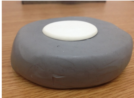
Fig. 3.11 Copierea negativului amprenteii cu ipsos
