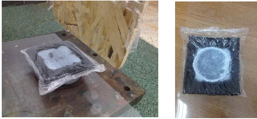
Fig. 3.8 Material poros spacer 3D negru îmbibat cu pastă de dinți inițial pe o arie de 60x60mm (stânga) ce s-a extins după impact până la 70 x 70mm (dreapta)
