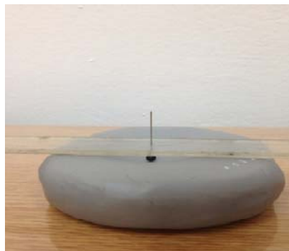
Fig. 3.10 Măsurarea adâncimii amprentei prin Metoda 1
